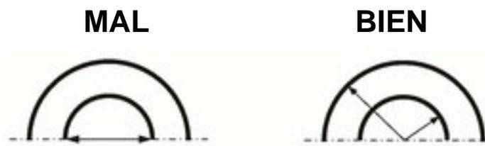
4º) Las líneas de cota deben ser paralelas al contorno de la figura y las líneas de referencia tienen que ser perpendiculares a los elementos que acotan.
